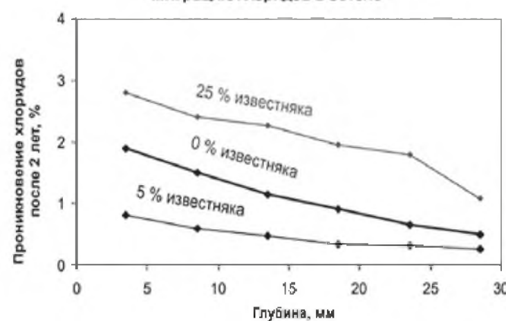
Воздействие цемента с добавкой известняка на миграцию хлоридов в бетоне
