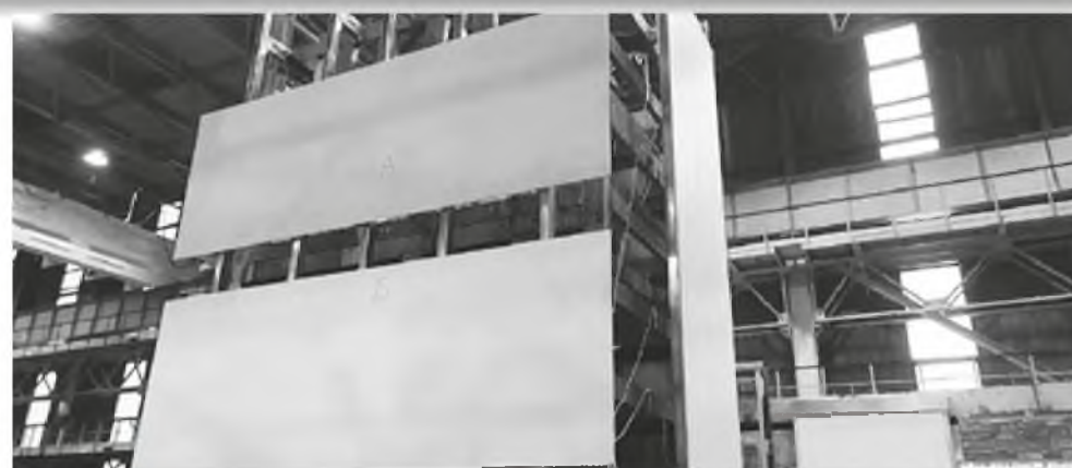
Так проводились сейсмические испытания плит «Виколор» со скрытым способом крепления
