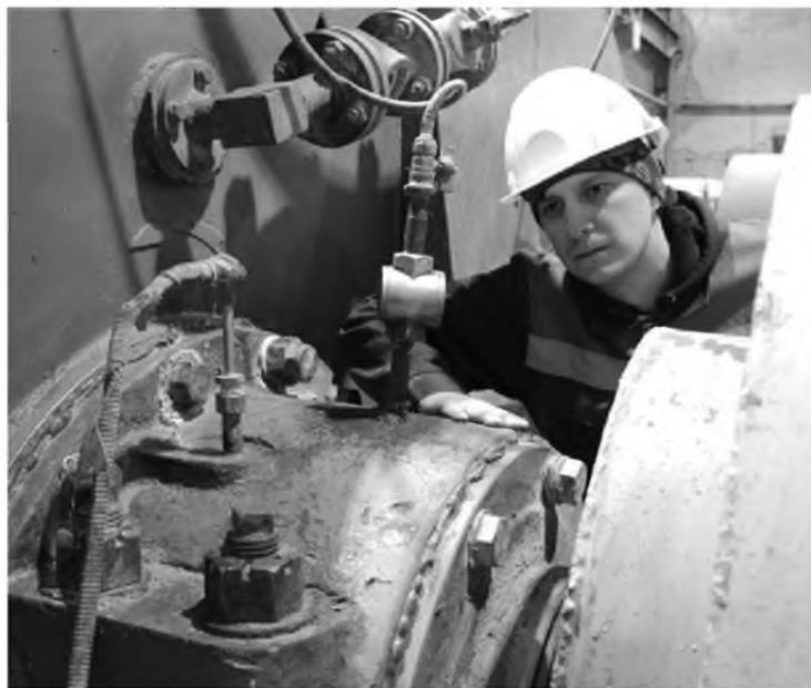
Артем Мялковский проверяет модернизированный редуктор на посторонние шумы и вибрацию
