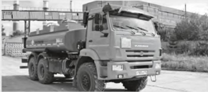
В цистерне два отсека: для бензина и дизтоплива
